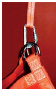
Abbildung 11-2: Karabinerhaken zur Aufnahme mehrerer Ösen
